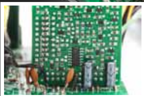
▶ Placa controladora de tensiones de salidas DC y protecciones
