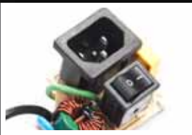
▶ Placa del toma AC/Interruptor con la primera etapa de los filtros de línea
