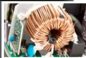
► Transformador de APFC y Placa controlador de Switching / APFC
