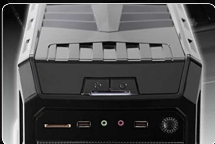
· PAINEL SUPERIOR: 1 PORTOS USB 2.0 & 1 PORTO USB 3.0 + PORTOS DE HD AUDIO Y MIC + CONTROLADOR DE FAN + CARD READER SD/MMC
