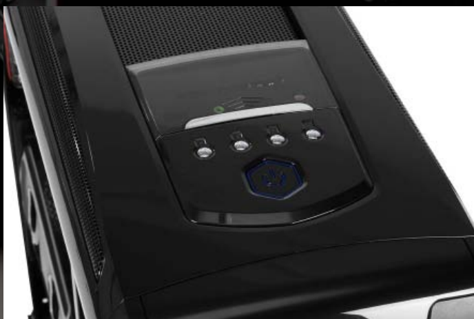
| · Panel superior: 4 Usb 2.0 + Hd Audio y Mic + 4 Controladores de Fan + E-Sata + Sata Nativo
